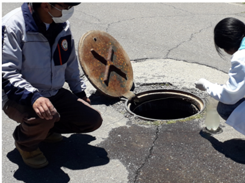
Figura 04: Toma de muestra del agua residual
